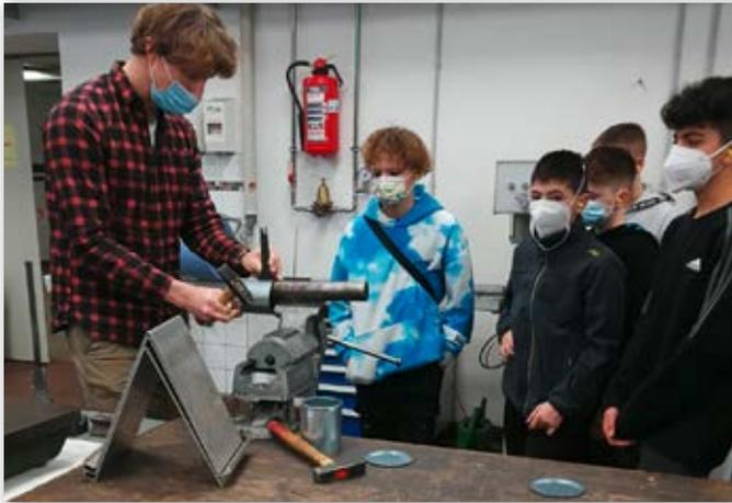
setzt. Um den unteren Blechrand zu schweißen, wird das Blech mit dem Höhenreißer angerissen. Der umzuformende Mantelfalz wird anschließend in drei Schritten auf 30, 60 und 90 Grad umgeformt. An der Schleifmaschine wird der Mantelfalz dann zurechtgeschliffen. Nun erfolgt die Fertigung des Bodenfalzes, der den Mantel mit dem Boden verbindet. Das Endprodukt kann sich sehen lassen.
